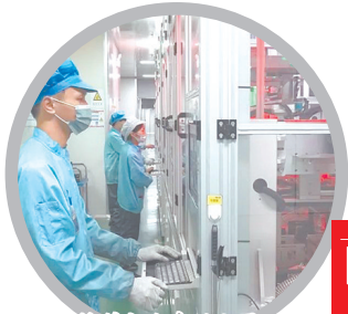
南昌维科电池有限公司 钠离子电池生产线。
